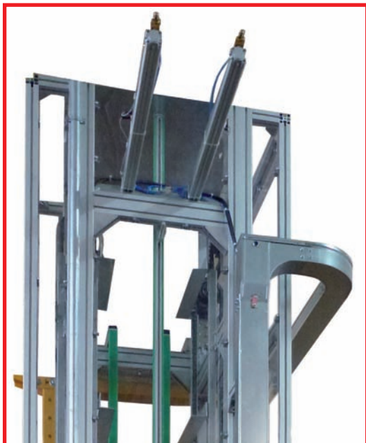
Sistema di trasferimento scatole da ascensore a rulliera Boxes transfer system from the elevator to the roller
