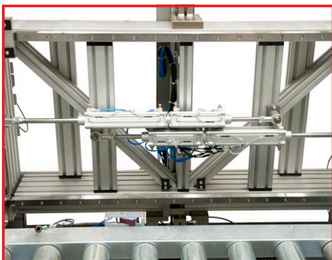
Sistema automatico di adattamento bracci a diversi formati pallets Automatic system for arms adjustment to different sizes
