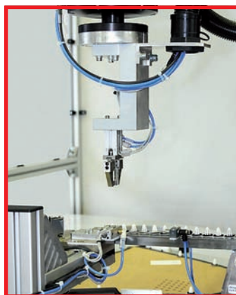
Gruppo di presa pinetto con pinza pneumatica Pin handling system by pneumatic gripper
