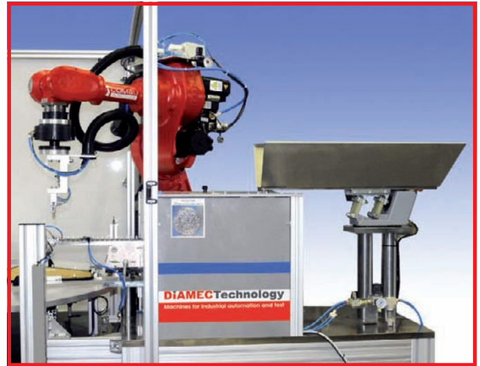
Sistema automatico di alimentazione ed orientamento pinetti Automatic pins feeding and orientation system
