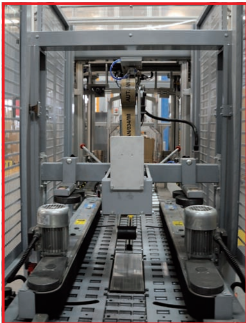
Sistema di regolazione altezza scatola Box height regulation system
