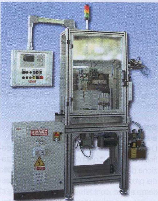
Banco controllo altezza e oliatura piattelli pompanti.
